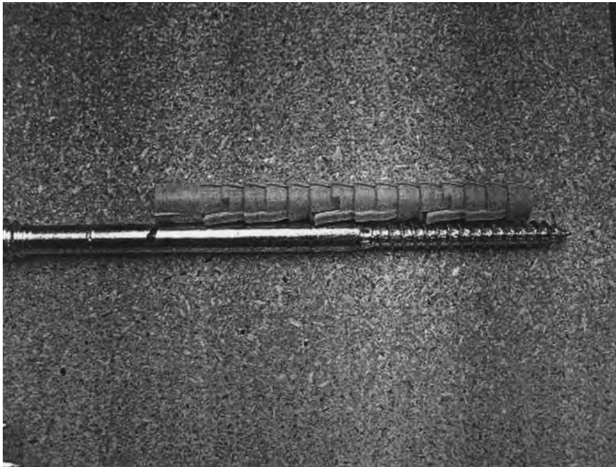
Die Toptec wurde auf einer Länge von 100 mm eingeschraubt
